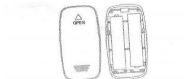
Obr. č.3 Umístění baterie
